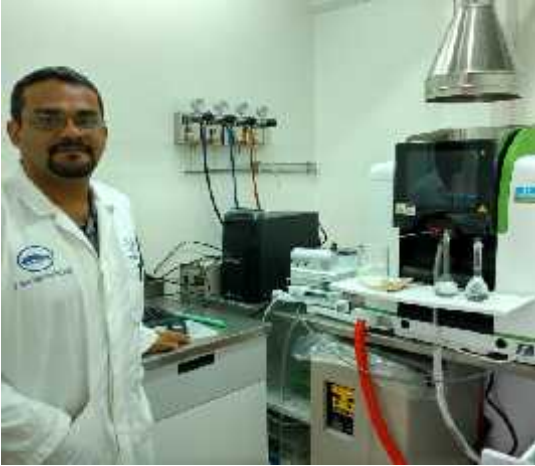
Espectrofotómetro de absorción atómica, Perkin Elmer, Modelo PinAAcle 900 con atomizador de horno de grafito y flama, con automuestreador
