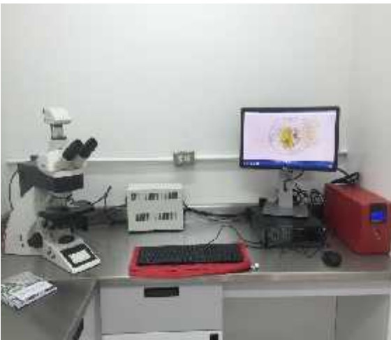
Microscopio AXIO Imager A2 marca Carl Zeiss, cuenta con dos formas de luz Transmitida y Epifluorescencia
